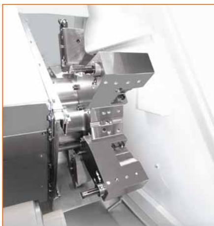
Standard 12-fach Werkzeugwechsler mit einer Werkzeugwechselzeit von 0.45 Sek. (Vertus 220)
