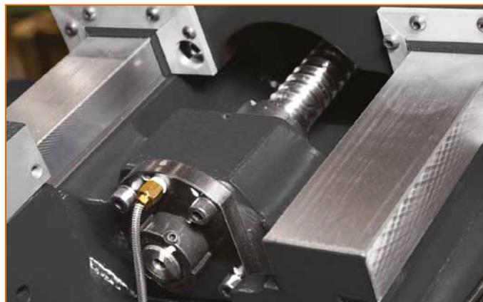
Präzise Vierkantführungen für dauerhafte Genauigkeit und Stabilität
