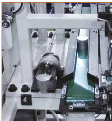
*Autom. Turn-On Station ermöglicht beidseitige Bearbeitung Ihrer Werkstücke ohne Eingriff des Bedienpersonals (Option)*
